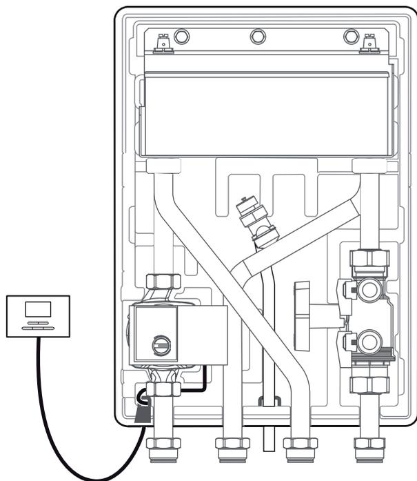
El cableado externo deberá ponerse a tierra, con las polaridades adecuadas y de conformidad con las normas vigentes.
